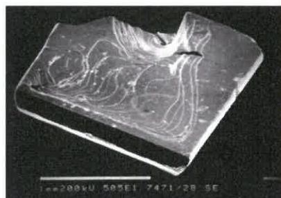
Rys. 58. Fotografie SEM monokryształów \text{UCoGa}_5 otrzymanych z użyciem In jako topnika.
